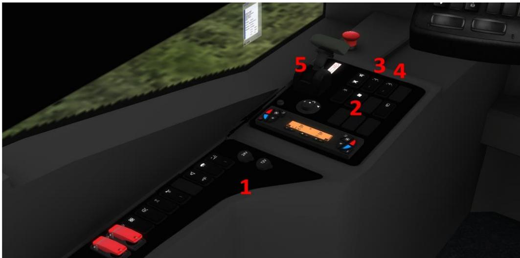
1: Elektrisches Frontrollo. Je nach Kipprichtung des Tasters wird das elektrische Frontrollo hoch oder runtergefahren.
