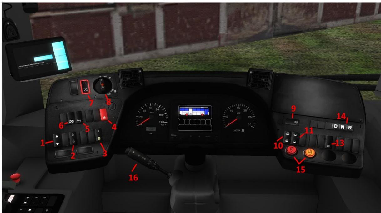
1: Display durchschalten: Schaltet das Zentralsdisplay durch um z.B. Anzeigen wie den aktuellen Vorratsdruck o.Ä. anzeigen zu lassen.
